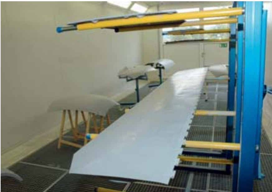
Die in Einzelteile demontierten Flugzeuge werden in der 12,5 mal 5 Meter große Lackierkabine beschichtet.
