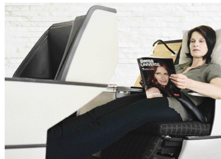
< So vergeht die Zeit im Flug: Im Business-Class-Sitz aus glasfaserverstärktem Kunststoff lassen sich Unterhaltungsinstrumente und Ablageflächen verbergen.
