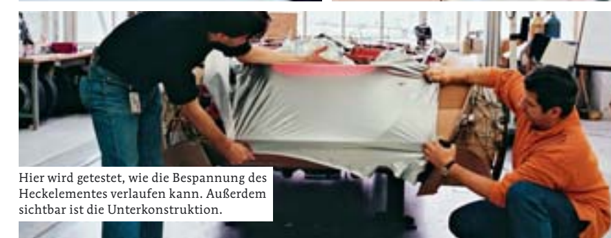
Die Bespannung erforderte eine für den Autobau neue Technik, das Know-how dazu holte man sich aus dem hauseigenen Sitzmusterbau.
