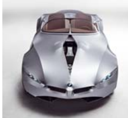
Der zweiseitige Roadster zeigt zwar markentypische Merkmale des aktuellen BMW-Designs, doch sein Kleid besteht aus einem elastischen Gewebe. Die Motorhaube ist keine solche, eine Mechanik zieht das Gewebe zur Seite.
