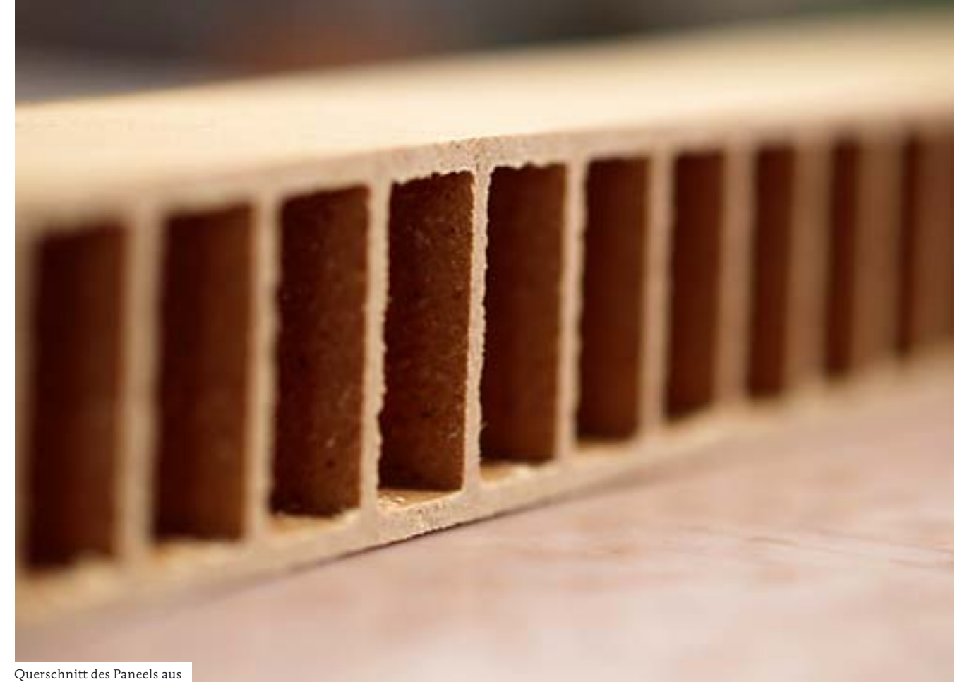
Querschnitt des Panels aus WPC: Die Kammerstruktur verbessert die Aussteifung und reduziert Gewicht wie Materialbedarf.
