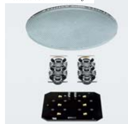
Reflektoren haben ausgedient: Kollimator-Optiken parallelisieren bei Erco das LED-Licht, die Spherolit-Linse steuert die Lichtverteilung ...
